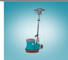
La monobrosse est une machine de nettoyage qui travaille par friction. Etant conçue pour accepter de nombreux accessoires, elle est très adaptable et elle permet donc de pratiquer de très nombreuses techniques d'entretien des sols : le lavage, le lustrage, le décapage, le ponçage... Elle est équipée d'un plateau et d'un disque ou d'une brosse. Elle s'utilise avec de l'eau, du produit ou à sec. C'est une machine qui peut être dangereuse si on ne respecte pas les règles d'hygiène et de sécurité.
